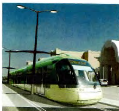
Translohr alimenté par caténaire inversée
